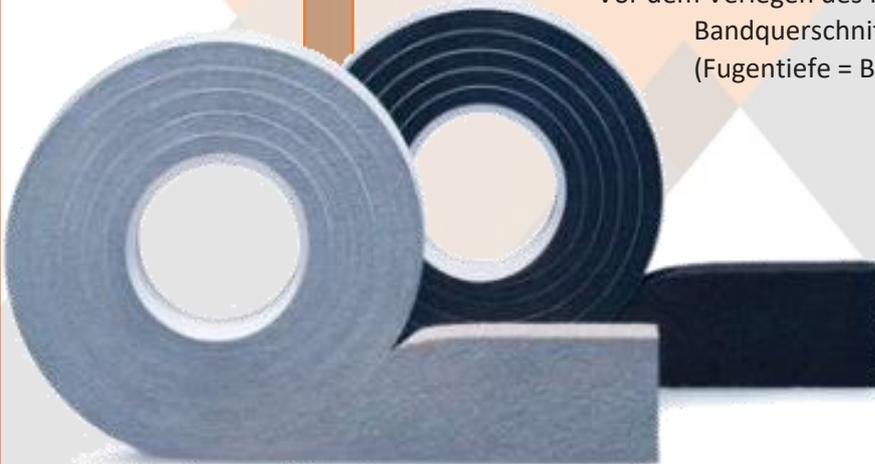
Fugenflanken bzw. Untergründe von Staub, Sand und losen Teilen reinigen. Weitere Vorarbeiten sind in der Regel nicht erforderlich. Vorlaufstreifen abnehmen und Bandenden gerade abschneiden. Abdeckfolie ca 10-20 cm von der Klebeschicht abziehen, Band in die Fuge einkleben und dabei Abdeckfolie gleichzeitig weiter abziehen. Selbstklebeseite mit dem Spachtel oder mit der Hand gegen die Fugenflanken bzw. das Montageteil drücken.
